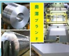
ロール状に巻かれた薄い鉄「コイル」を大型ラインで平らにし、切削加工した『板』コイルを分割しさらに細く切削加工した『スリットコイル』ご要望のサイズ・形状へ加工し、東日本全域約350社のお客様へ販売しています。
